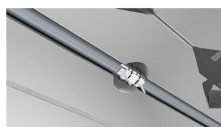
Alternativ kann für das Setzen der Feuchtefühler und/oder Pressverbinder auch eine Lochsäge mit min. 60 mm Durchmesser verwendet werden. Hier kann die Öffnung auch noch erstellt werden, wenn das Modul bereits hängt.
