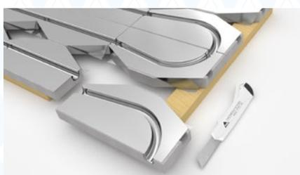
Damit das Systemrohr mit der Anbindeleitung ordentlich verbunden werden kann, muss der äußerste Halbbogen ausgeschnitten werden.
