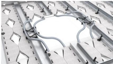
Es können pro CD-Profil maximal 2 Systemrohre verzogen werden. Dazu werden diese versetzt auf beiden Seiten eingelegt.
